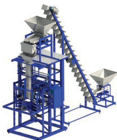
Widok z przodu z dodatkowym podajnikiem kubetkowym
